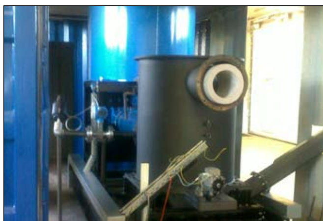
Prototyp energetické jednotky na zplyňování biomasy
